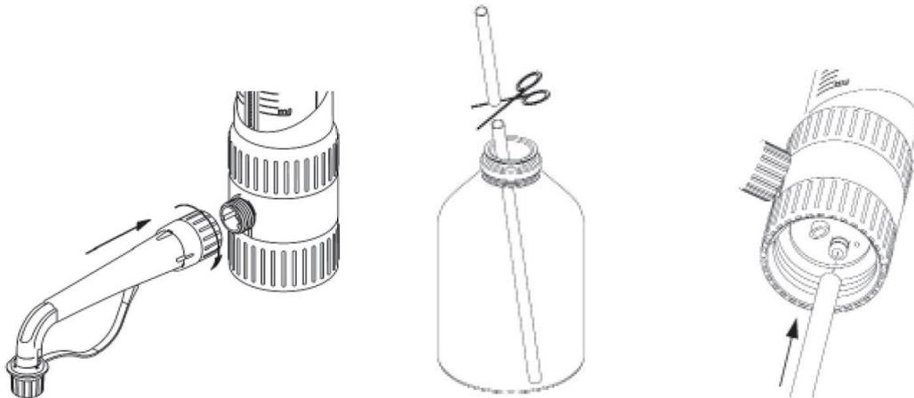
Fig.1 排出チューブ取付け      Fig.2 吸引チューブ切断      Fig.3 吸引チューブ取付け
