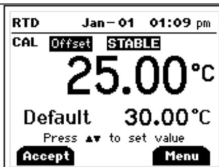
▲▼キーを使用して既知の標準温度に数字を調整してください。調整した値を確定するには、F1 (Accept) キーを押してください。F3 (Menu) キーを押すと、メニューに戻ります。
