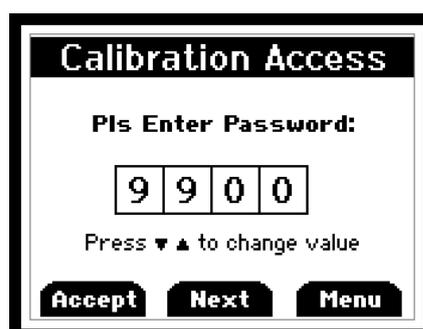
校正モードに移動する前にパスワードを入力する必要があります。▲▼キーで値を変更し、次の項目に移動するには F2 (Next) キーを押してください。(既定値のパスワードは、「9900」)です。入力したパスワードで良い場合、F1 (Accept) を押して確定してください。校正方法選択メニューに移動します。
