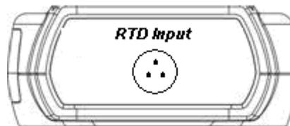
温度センサーが本体に接続されていない場合や不良の場合、本体主表示部に OPEn と表示されます。
