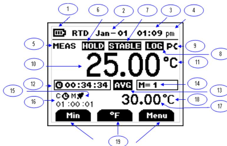
ドットマトリックスディスプレイは、上段の主表示部と下段の副表示部からなります。副表示部では、チャンネル情報や、MAX/MIN/AVG 情報を表示します。
