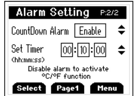
▲▼キーを使用して、設定する項目に移動してください。設定する項目移動した後、F1 (Select) を押すと項目内容の画面に移動します。▲▼キーを使用して、値を設定してください。F1 (Accept) を押すと入力値が確定されます。F3 (Esc) キーを押すとアラーム設定を中止します。
