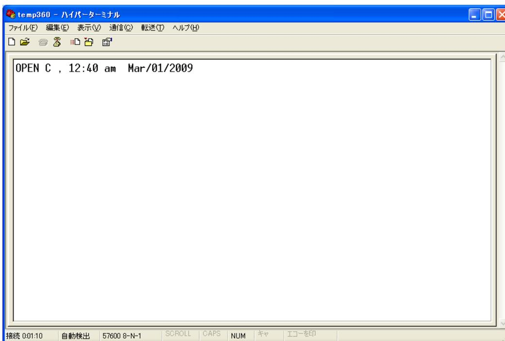
センサーが接続されていない状態でデータ転送したため、OPEN と表示
