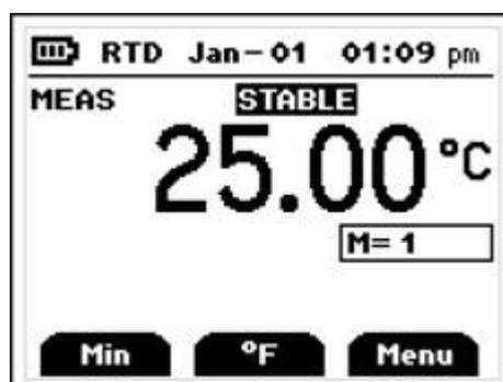
初めてご使用頂く時の主表示部には、測定値が表示されます。F2(°F)キーを使用すると主表示部の表示温度単位が°C、°Fと変更することが可能です。
