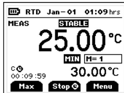
(注意) カウントダウンアラームを設定した場合、測定モード中の温度表示単位の切り替えは不可能です。またカウントダウンタイマーを設定した時には、カウントダウンが終了するまでオートパワーオフ機能が無効になります。本器の電源を OFF にした場合、カウントダウンアラーム機能は自動的に無効になります。
