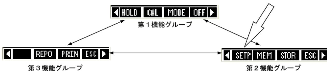
SETUP キー (F1) を押し、セットアップモードに入ると、最初に下のような画面が表示されます。ここではセットアップモードにおけるキーファンクションが説明されています。
