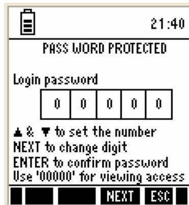
パスワードロックを解除し、セットアップモードや校正モードに入るには下記手順で実施します。
