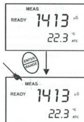
もし、測定サンプルの値が選択されたレンジよりも高い場合には、主表示画面に Or と表示されます。この時は再度 RANGE ボタンを押して測定レンジを選択し直してください。
