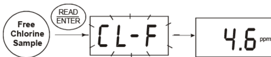
遊離残留塩素測定の流れ
