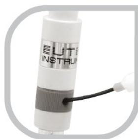
再充填ボトル（すべての電極に供給されています）で参照電解液を注ぎます。
