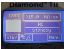
RO Standby モード、純水運転のスクリーン
