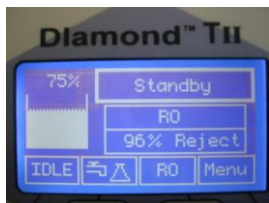
RO 運転、純水 Standby モードのスクリーン
